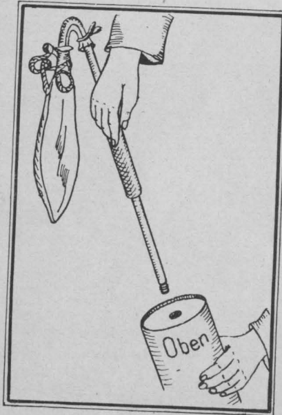
Abb. 9. Gaserzeuger: Einschrauben des Füllrohrs
